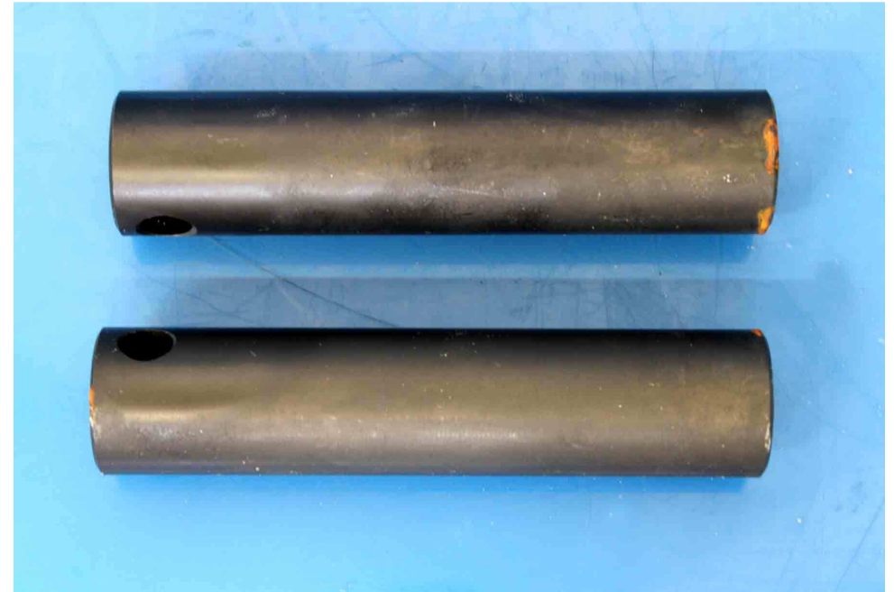
Figura 4. N°1 y N°2 (800 horas) : Aspecto que presentan las piezas tras 800 horas de ensayo.
