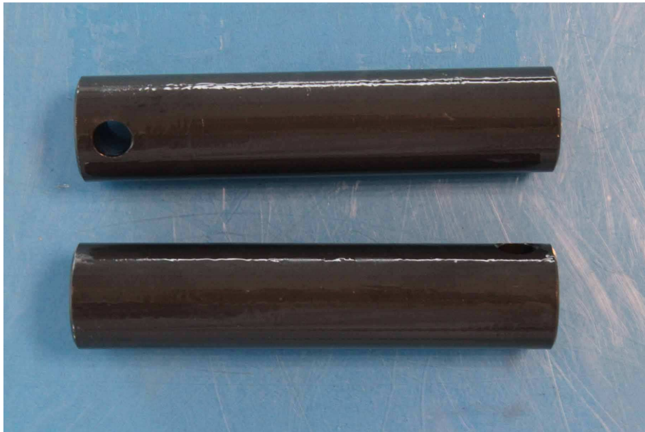
Figure 1. Nº1 y Nº2 : Aspecto que presenta la pieza antes del ensayo de niebla salina. Figure 1. No.1 and No.2 . Aspect of the part before the salt spray test exposure.
