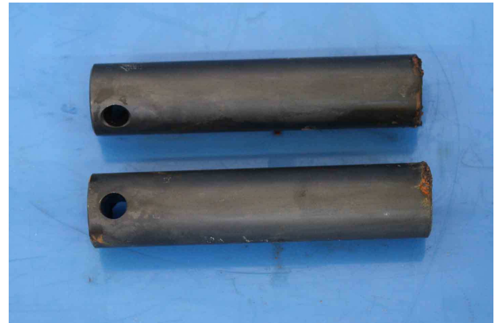
Figura 2. Nº1 y Nº2 (1416 horas) : Nivel de corrosión que presenta la pieza tras el ensayo. Figure 2. No.1 and Nº2 (1416 hours) . Corrosion level of the part after the exposure time.
